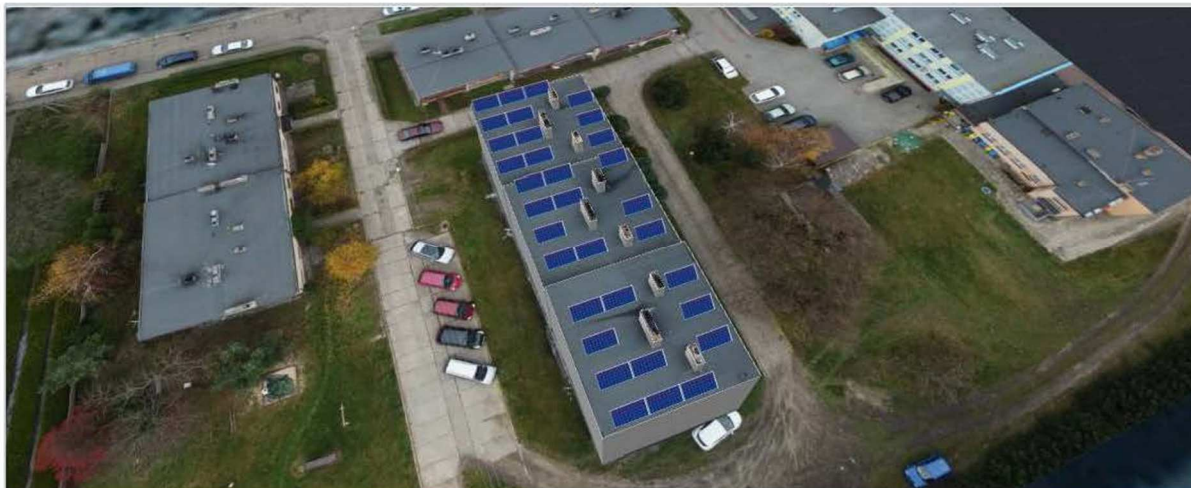
Rysunek 1 Koncepcja rozmieszczenia modułów PV
