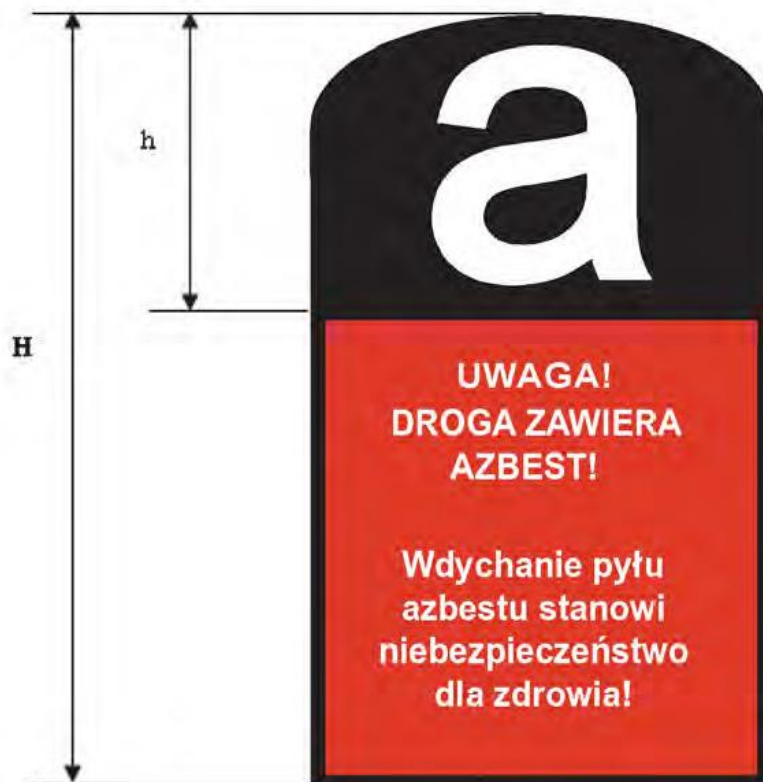
Rys. 4. Wzór oznakowania dróg utwardzonych odpadami zawierającymi azbest
