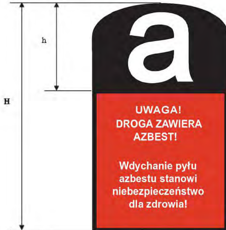
Rys. 4. Wzór oznakowania dróg utwardzonych odpadami zawierającymi azbest
